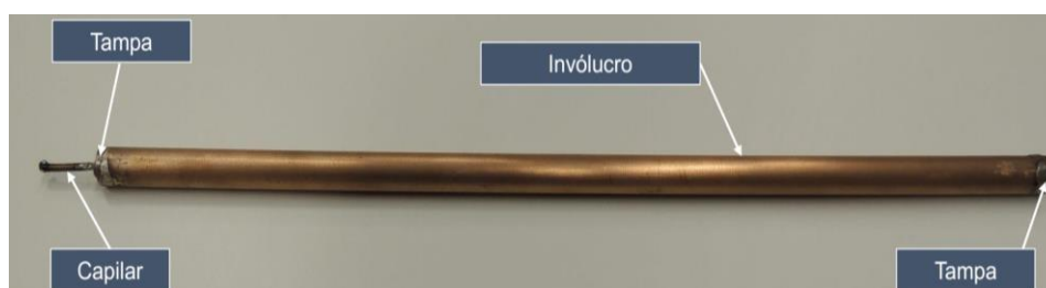
Figura 4 - Montagem do tubo de calor e do termossifão.
