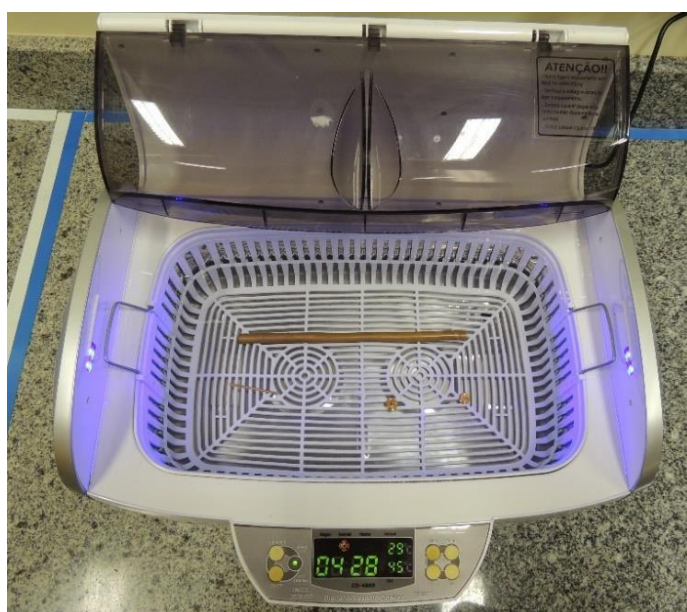
Figura 3 – limpeza dos componentes no banho ultrassônico.
