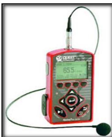
Figura 9 – Audiodosímetro QUEST NOISE PRO.
