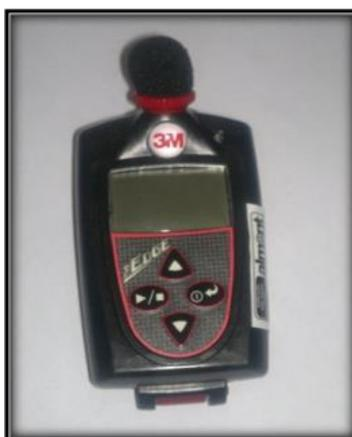
Figura 8 – Audiodosímetro QUEST EDGE 5.
