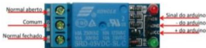
Figura 7 - Módulo relé com seus terminais discriminados.
