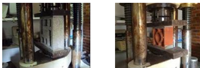
Figura 3: Detalhe da prensa hidráulica durante o ensaio de resistência à compressão dos blocos EVAzados e blocos cerâmicos. Fonte: Acervo dos autores
