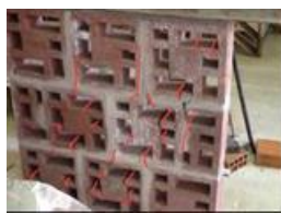
b) painel com bloco EVAzado pigmentado assentados com rotação em 90º com ruptura dútil
