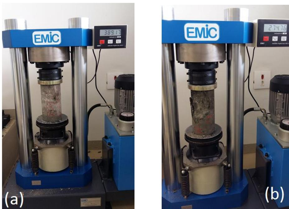
**Figura 4.** (a) rompimento do traço testemunho Rico aos 28 dias (b) rompimento do traço testemunho Comum aos 28 dias, dados em KN.
