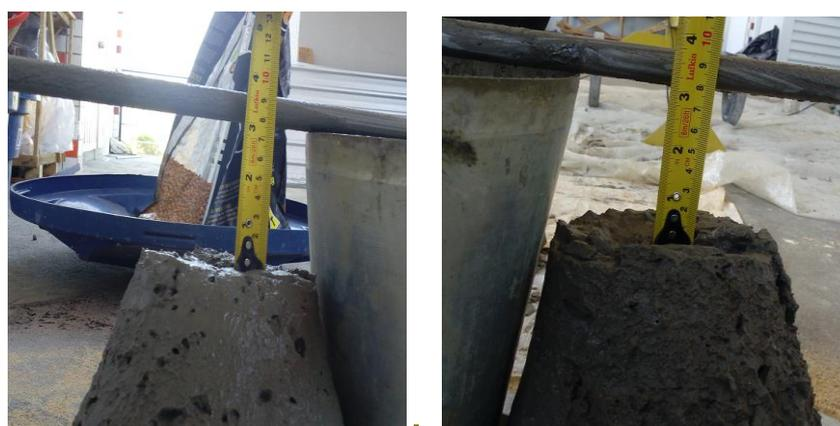
**Figura 3.** ensaio do abatimento do concreto (*Slump Test.*)
