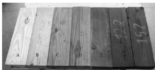
Figura 1 – Alteração nas cores da madeira tratada termicamente: (A) testemunha (madeira in natura ); (B): 160 °C; (C): 180 °C; (D): 200 °C; (E): 220 °C; (F): 240 °C; (G): 260 °C. Fonte: Silva (2012).
