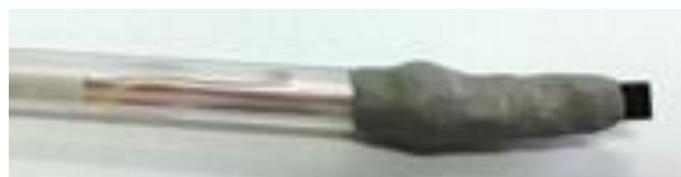
Figura 2: Acoplamento de Sensor de Temperatura em Tudo de Acrílico.
