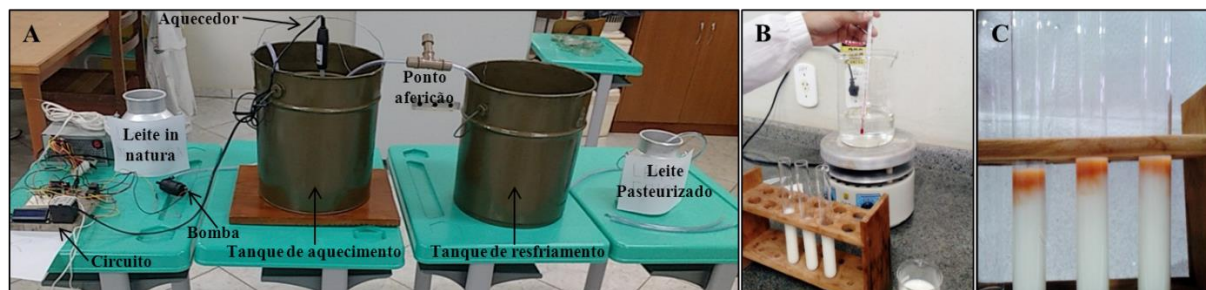
Figura 7: Pasteurizador (A), Análise de peroxidase (B) e Resultado da análise (C).
