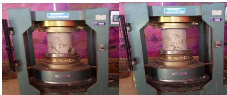
Figura 5 - Ensaio de resistência a compressão do concreto
