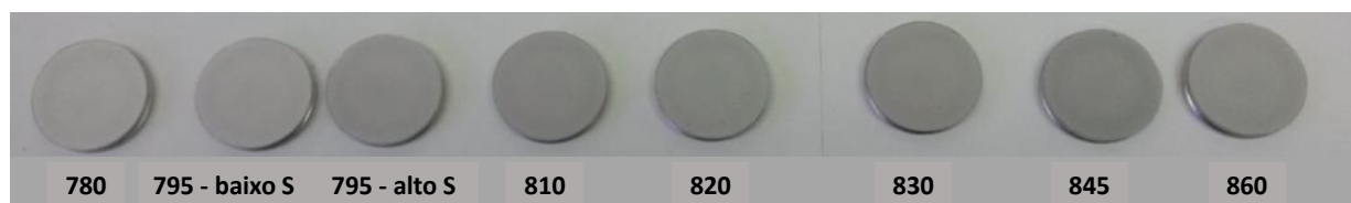
Figura 1 – Pastilhas confeccionadas para análise FRX.
