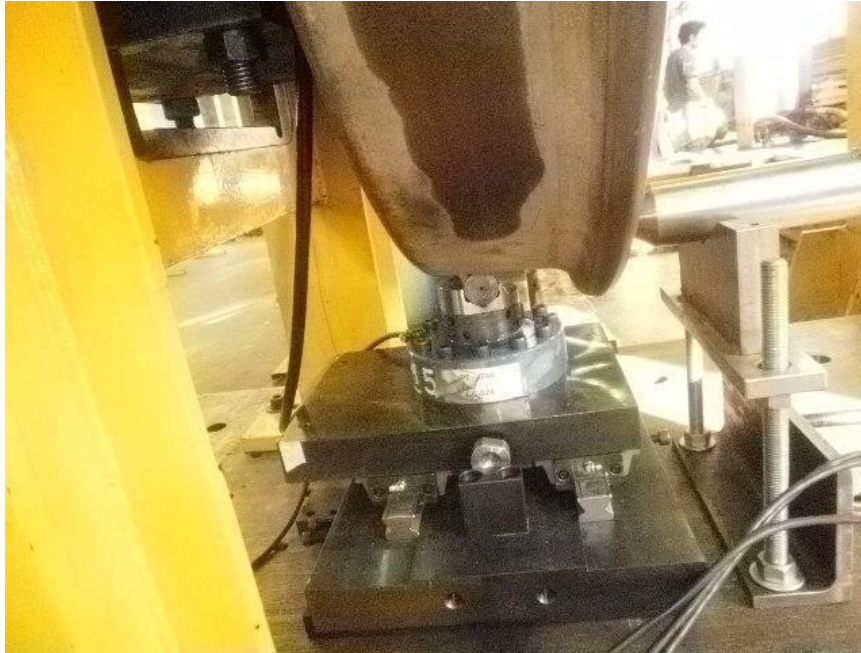
Figura 3 - Contato entre roda e base em bancada de simulação
