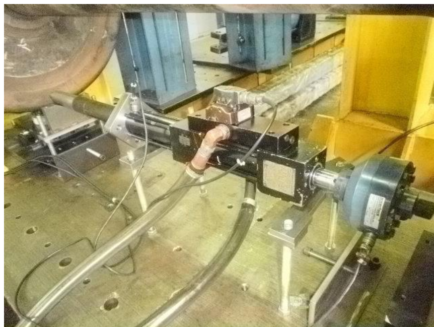
Figura 5 - Pistão para aplicação de força lateral
