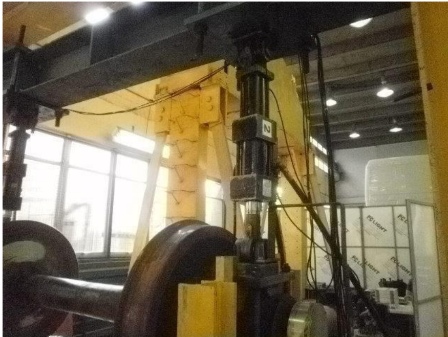
Figura 4 - Posicionamento do pistão para aplicação de força vertical
