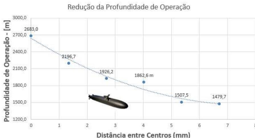
Figura 12: Redução da profundidade máxima de operação conforme amplitude da falha geométrica
