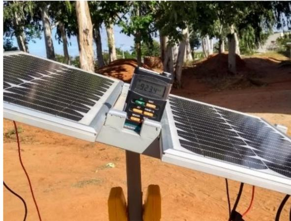
Figura 10 – Processo de análise da radiação solar incidente
