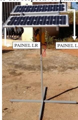
Figura 6 – Base estrutural do sistema fotovoltaico para medição
