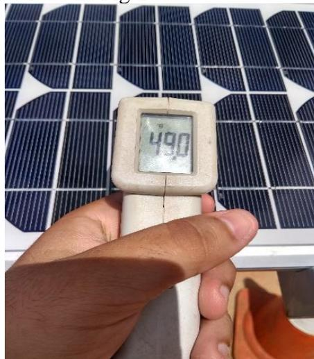
Figura 9 – Processo de análise da temperatura do módulo
