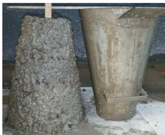
Figura 5 - Abatimento do tronco de cone do traço TE3.
