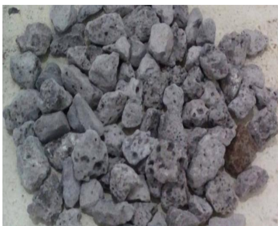
Figura 4 - Fração da escória 12 a 19 mm retida na peneira de 12,5 mm.
