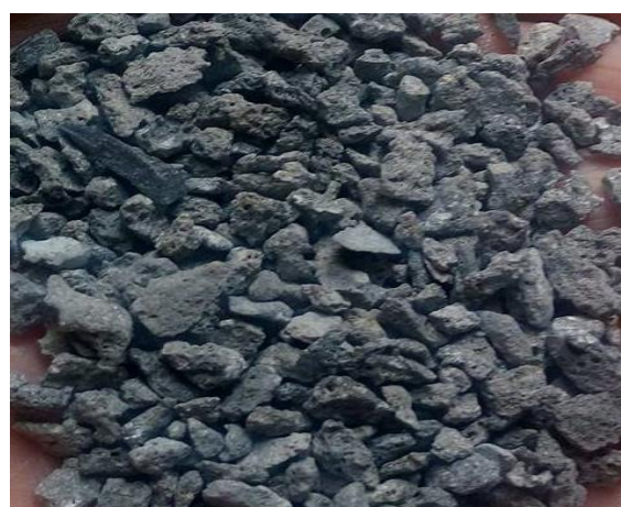
Figura 1 - Fração da escória (0 a 5 mm) retida na peneira de 2,36 mm.
