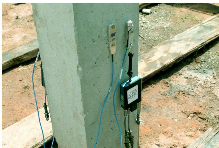
Figura 3 – Seção de estaca instrumentada para a realização de ensaios de carregamento dinâmico.
