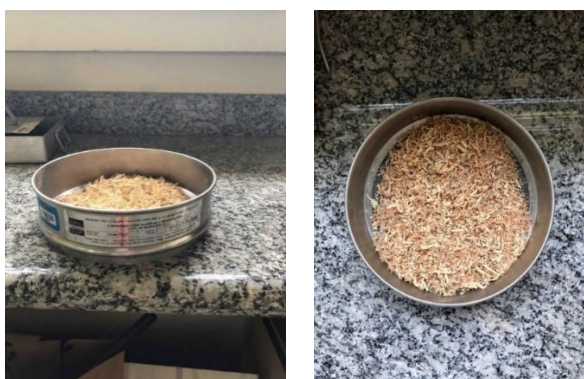
Figura 1. Peneiramento do Resíduo
