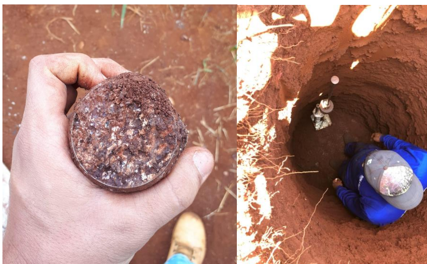
Figura 3 – Amostra indeformada coletada e ensaio CPD sendo realizado em profundidade
