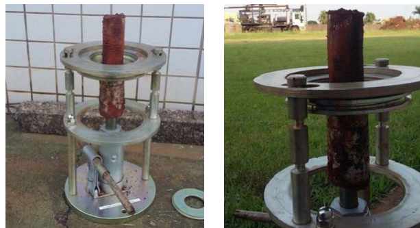
Figura 1. Retirada de amostra indeformada do molde metálico com macaco hidráulico de laboratório.
