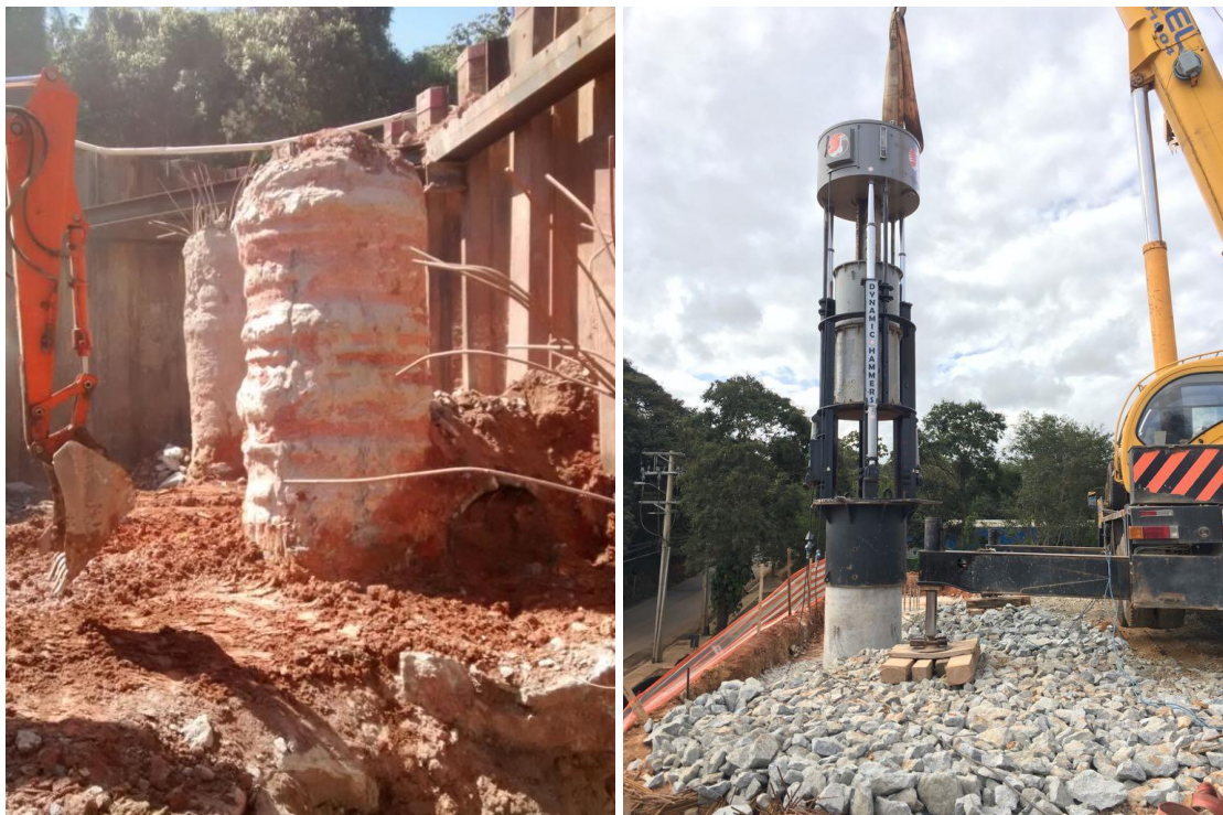
Figura 1 - (a) Estaca teste ensaiada, (b) Ensaio PDA martelo 25 tf. Fonte: autor.
