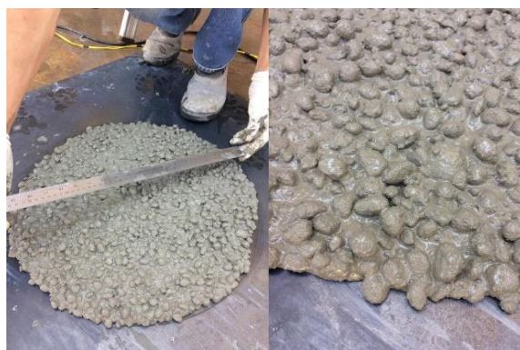
Figura 3 - Aspecto do CLAA no estado fresco após o slump flow test
