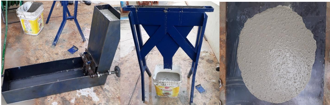
Figura 2 – Ensaio de caracterização do concreto no estado fresco, sendo da esquerda para a direita Caixa L, Funil V e Slump-flow test
