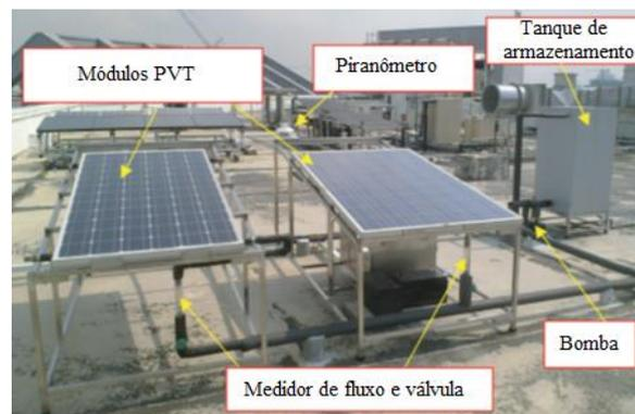
Figura 10. Módulos PVT instalados.
