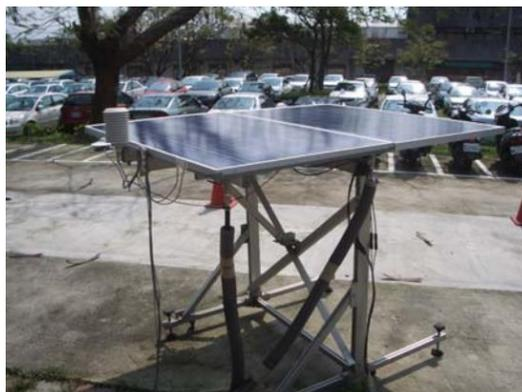
Figura 11. Coletor PVT montado.
