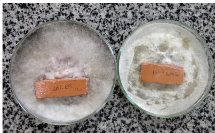
Figura 3.8: Resultado do teste microbiológico da telha 16%EPS e da telha 16%EPS + 0,04% de Cobre após 07 dias.
