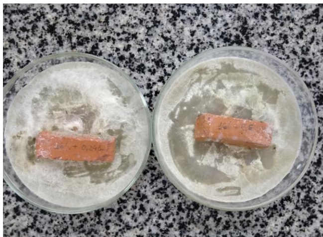
Figura 3.9: Resultado do teste microbiológico da telha 16%EPS + 024% de cobre e da telha 16%EPS + 0,5% de Cobre após 07 dias.
