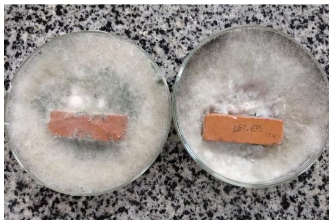
Figura 3.7: Resultado o teste microbiológico da telha sem tratamento e telha 16%EPS após 07 dias.
