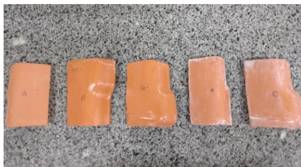
Figura 3.4: Aspecto visual das telhas sem tratamento, com 16%EPS, 16%EPS+ 0,04% de Cu, 16%EPS + 0,24% de Cu e 16%EPS + 0,5% de Cu, da esquerda para a direita, respectivamente.
