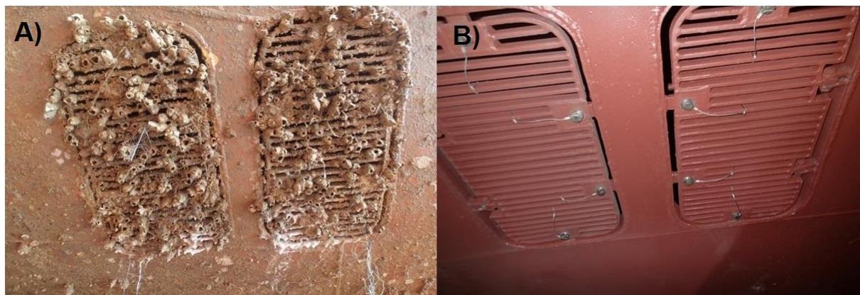
Figura 2 - Bioincrustação na entrada da caixa de mar de um navio.
