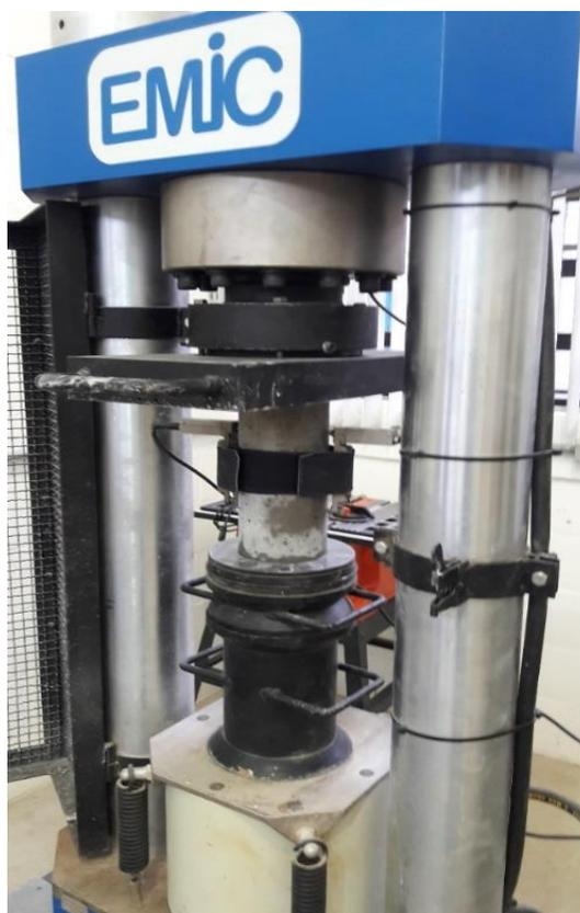
Figura 3 – Ensaio módulo estático de elasticidade à compressão. Fonte: Autor.
