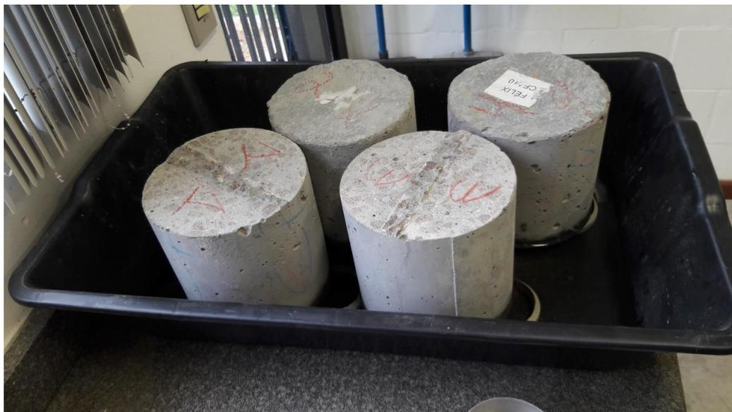
Figura 2 – Ensaio de absorção de água por capilaridade. Fonte: Autor.
