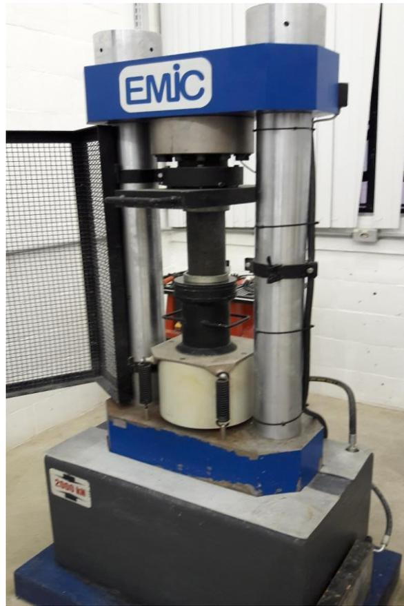
Figura 1 – Ensaio de resistência a compressão em corpos de prova cilíndricos. Fonte: Autor.
