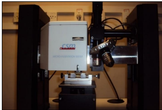
Figura 3 — Equipamento de microindentação instrumentada pertencente ao Laboratório de Polímeros do Programa de Engenharia Metalúrgica e de Materiais da Coppe/UFRJ.
