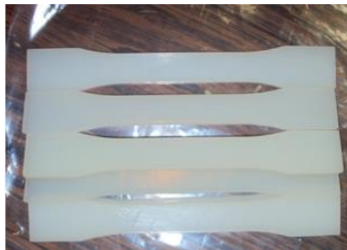
Figura 2 — Corpos de prova de PA-11 fabricados via moldagem por compressão (c).
