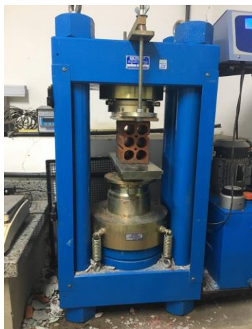
Figura 3 – Amostra sendo rompida
