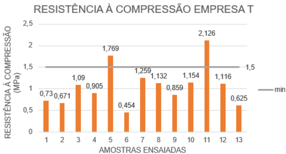
Figura 7 – Resultados do ensaio de resistência a compressão cerâmica T
