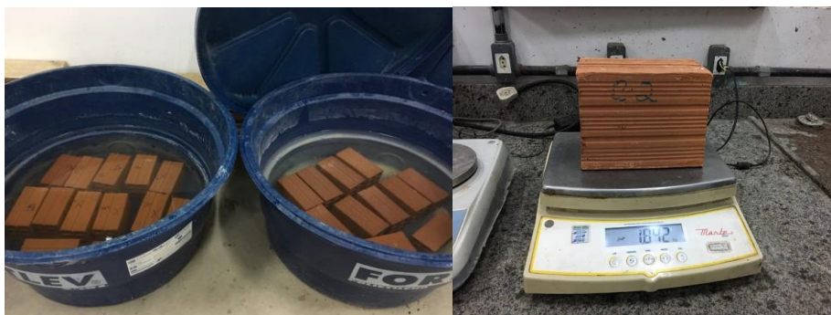
Figura 2 – Amostra submersas em água (a) e a amostra sendo pesada (b)
