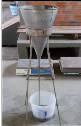
Figura 2 - Ensaio no Cone de Marsh
