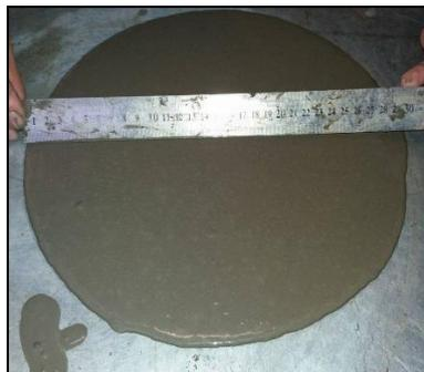
Figura 3 - Ensaio de espalhamento (*Slump flow*)
