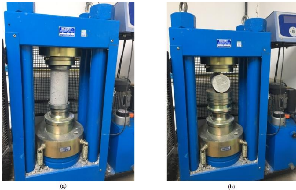
Figura 4 – Ensaio de compressão axial (a) e ensaio de compressão diametral (b)
