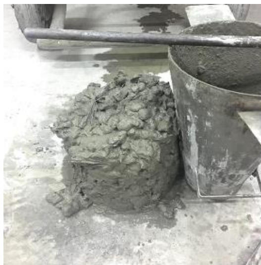
Figura 5 – Ensaio de abatimento
