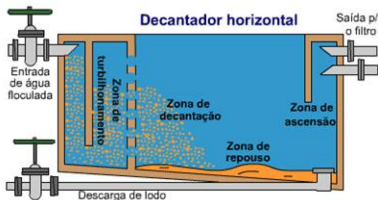
Figura 06 — Demonstração das zonas típicas de um decantador similar ao da ETA—Itacolomi. (Fonte: Adaptado de GAUTO e ROSA, 2011).
