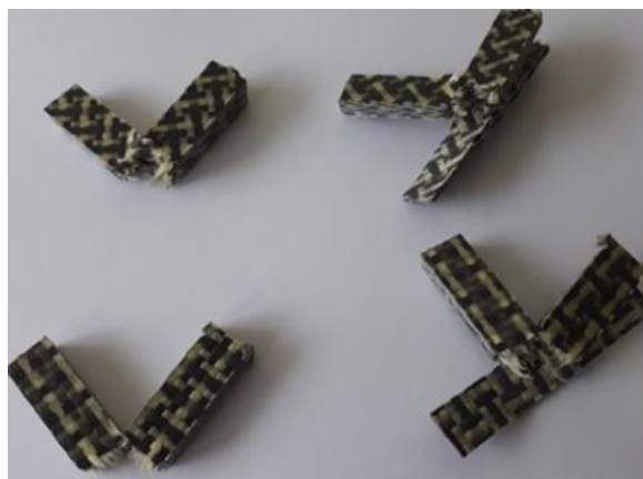
Figura 8 – Influência de delaminação nos CPs ensaiados
