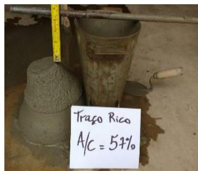
Figura 7: *Slump test* traço rico com relação a/c 57%.
