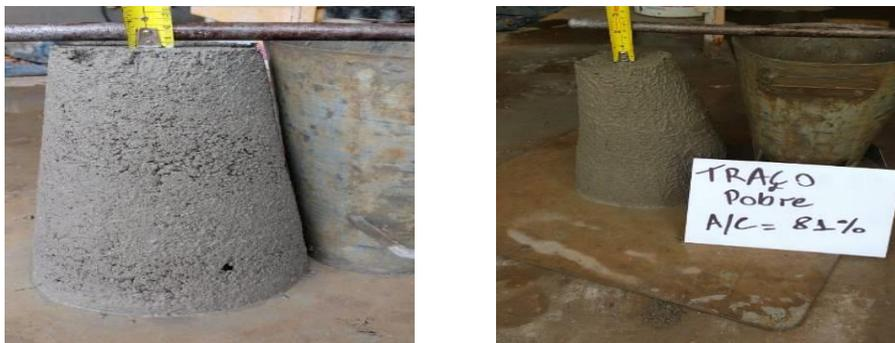
Figura 6: *Slump test* traço pobre com relação a/c 64% e 81%.
