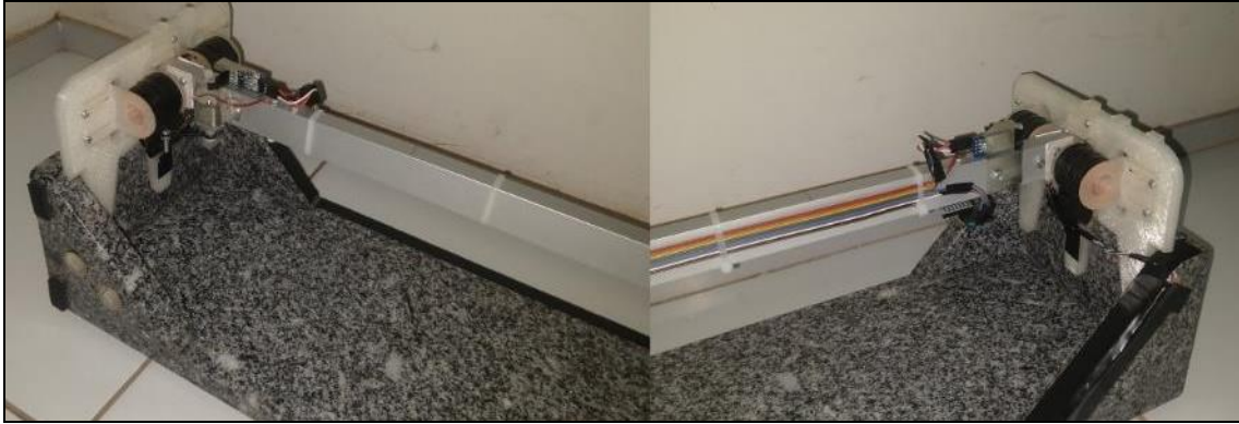
Figura 2 – elementos para atenuação da vibração do perfil.
