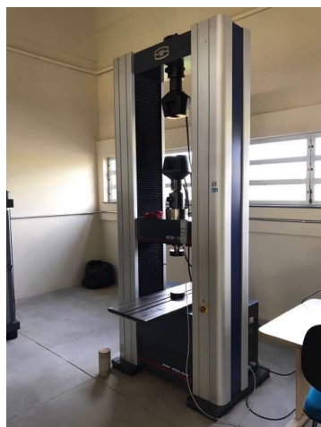
Figura 3 – Máquina de ensaio universal EMIC.
