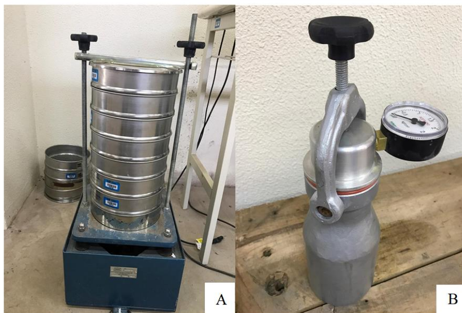
Figura 2 – Equipamentos utilizados: A) peneiras e agitador para granulometria; B) equipamento Speedy
