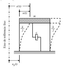
Figura 1 – Sistema de um grau de liberdade (CLOUGH & PENZIEN, 1995)
