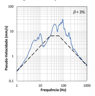
Figura 5 – Espectro de resposta e movimento do terreno calculado para o desmonte P-TP-002, nas obras de expansão do Canal de Panamá.
