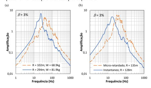
Figura 4 – Mudança de frequência dominante em função (a) da distância entre a detonação e ponto de monitoramento e (b) em função do uso de micro-retardos entre cargas
