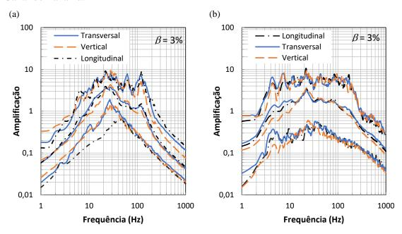
Figura 6 – Limites superior, inferior e médio das amplificações de pseudo-velocidades de partícula. Desmontes subaquáticos: (a) Porto de Santos e (b) Ampliação do Canal de Panamá.
