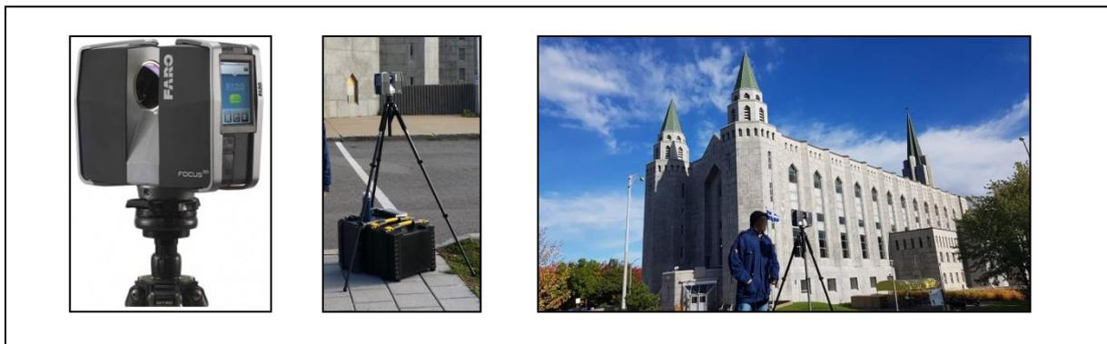
Figura 2: Escâner LiDAR Terrestre (TLS).
