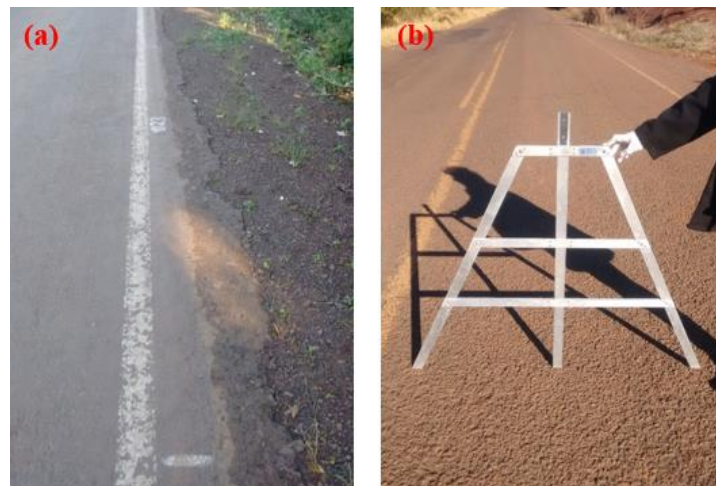
Figura 2 – a) Demarcação da superfície de avaliação; b) Medição dos afundamentos de trilha de roda
