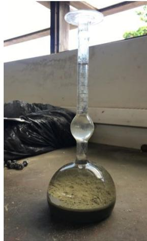
Figura 1 – Cimento sendo ensaiado quanto à massa específica
