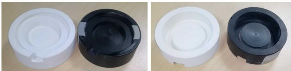
Figura 10 – Comparação entre as peças. À esquerda, a peça original e, à direita, peça fabricada através de MA a partir de modelo digital obtido com a utilização de técnicas de ER.
