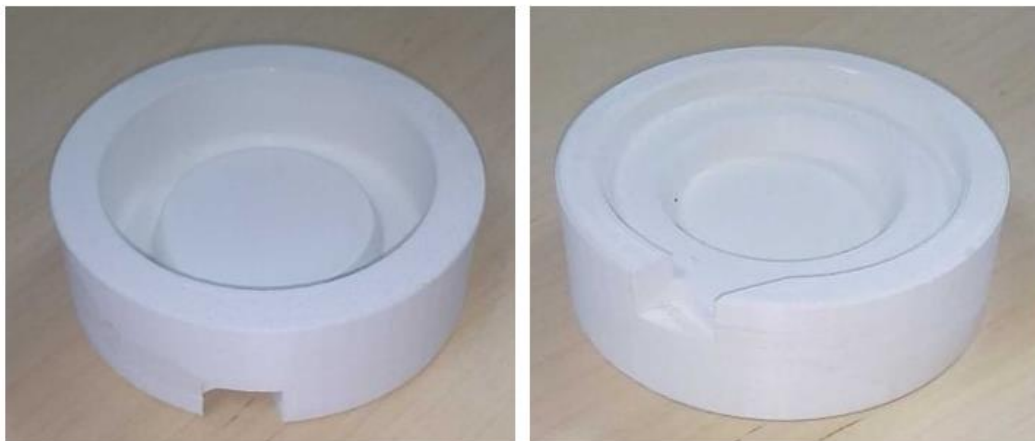
Figura 9 – Adaptador magnético, parte constituinte de um equipamento de circulação extracorpórea. Peça fabricada através de MA a partir de modelo digital obtido com a utilização de técnicas de ER.
