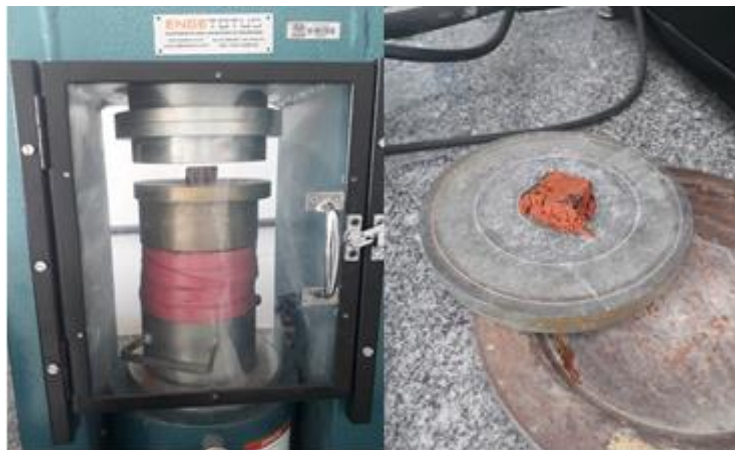
Figura 1 – Rompimento do corpo de prova
