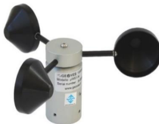
Figura 7 – Anemômetro WS1-V (GEOVES).
