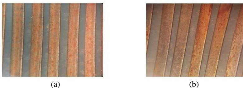
Figura 16 – Resistência elétrica bello banho ultra após a análise 5. (a) Comprimento maior (b) Comprimento menor
