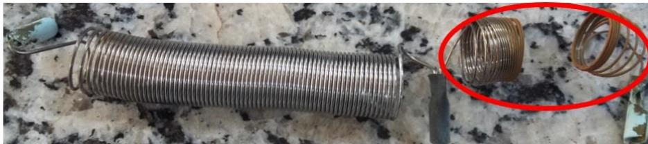
Figura 11 – Resistência maxi ducha após 40 horas de experimento utilizando água potável.
