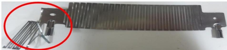
Figura 9 - Resistência bello banho ultra após 120 horas de experimento utilizando água destilada.
