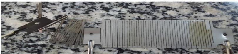
Figura 17 - Resistência bello banho ultra após 40 horas de experimento utilizando água destilada.
