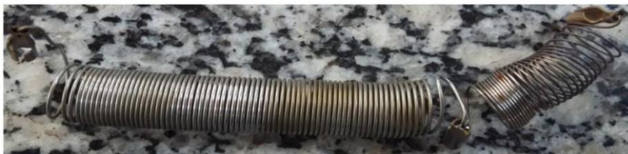
Figura 13 – Resistência maxi ducha após 40 horas de experimento utilizando água destilada.
