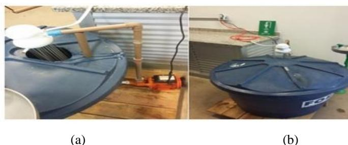
Figura 5 - Sistema hidráulico utilizado nos experimentos. (a) parte hidráulica (b) parte elétrica.
