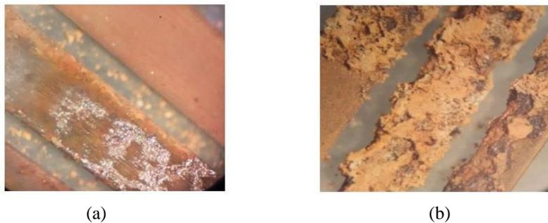
Figura 8 – Resistência elétrica bello banho após a análise 1. (a) Comprimento maior (b) Comprimento menor.
