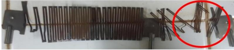
Figura 6 - Resistência bello banho ultra após 120 horas de experimento utilizando água potável.
