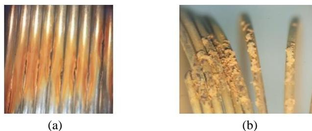
Figura 12 - Resistência elétrica maxi ducha após a análise 3. (a) Comprimento maior (b) Comprimento menor
