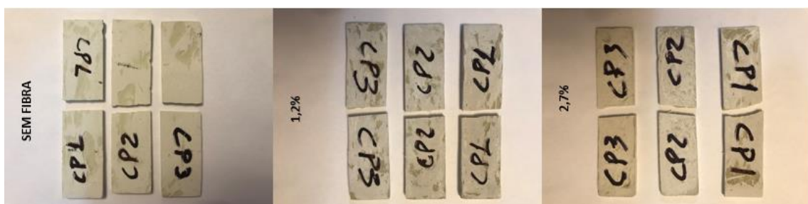
Figura 7 - Corpos de prova rompidos após ensaio de flexão.
