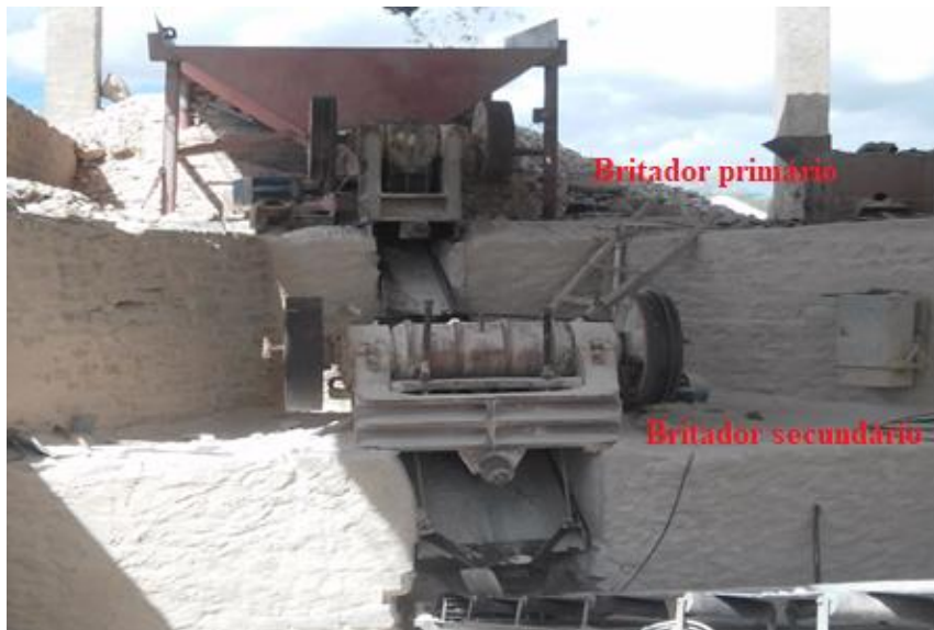
Figura 2 – Britador de mandíbulas primário e secundário da COOMIPEL.
