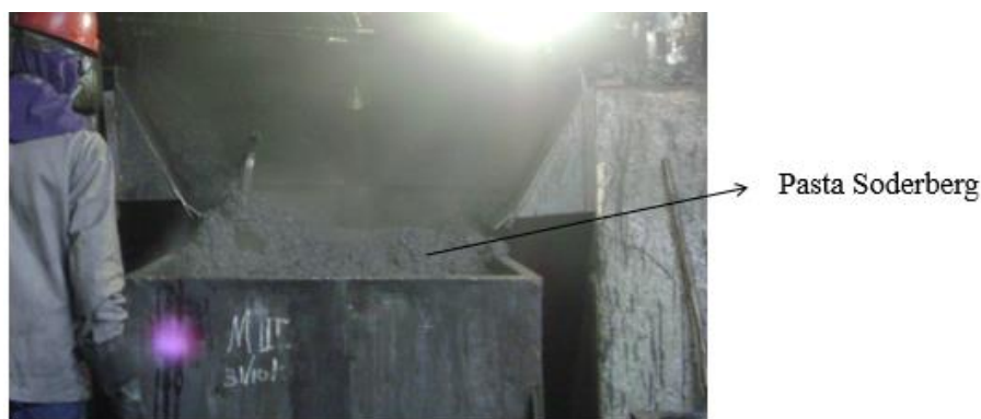
Figura 04 — Forma física do anodo de pasta Soderberg produzido pela Novelis de Ouro Preto/MG, no estágio adequado para alimentar as cubas eletrolíticas. (Fonte: Elaborada à partir do banco de dados coletados em visita técnica à Fábrica, 2020).
