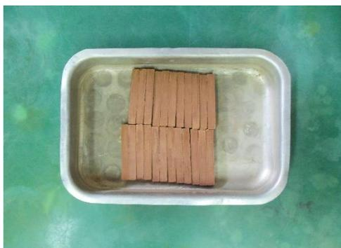
Figura 1 – Corpos de prova confeccionados por prensagem.
