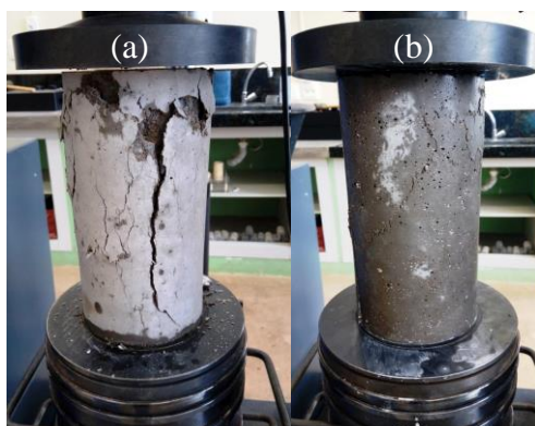
Figura 2 – Fraturas em corpos de prova: (a) traço T01; (b) traço T04.
