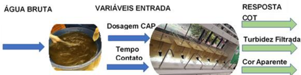
Figura 2 - Representação do planejamento experimental do DFC para o estudo das condições de aplicação dos CAPs.
