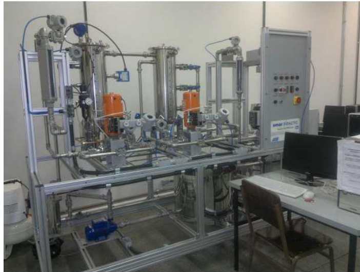
Figura 5 – Imagem real da planta didática industrial – possui todos os instrumentos de controle destinados à aplicação industrial – somente os processos são emulados – aquecimento e mistura – em escala reduzida
