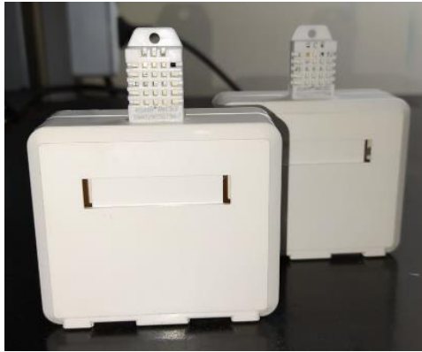
Figura 5 - Sensores DHT 22 nos suportes para instalação Fonte: Acervo do autor (2020)
