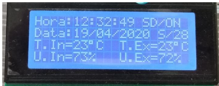
Figura 10 – Interface do usuário pelo display LCD Fonte: Acervo do autor (2020)
