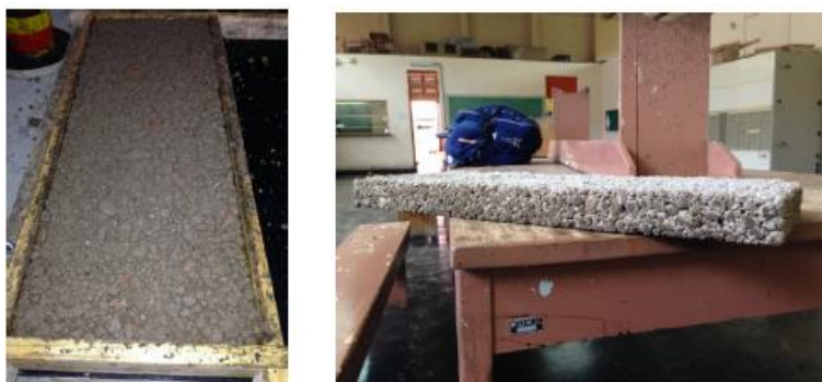
Figura 3- Placas de concreto para rompimento à tração na flexão
