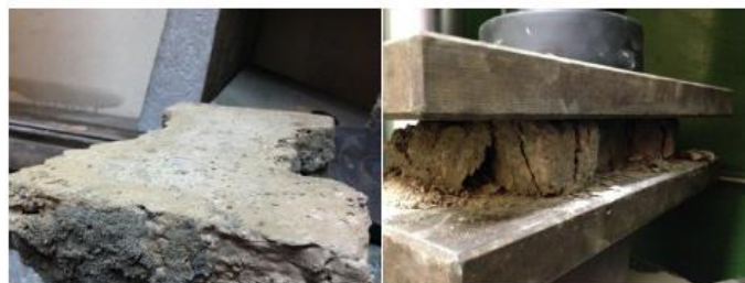
Figura 7 - Rompimento das peças de piso grama à compressão aos 28 dias do concreto 1:3:5 (6% + ABS.) realizado na Fábrica de Pré-Moldados da UEL
