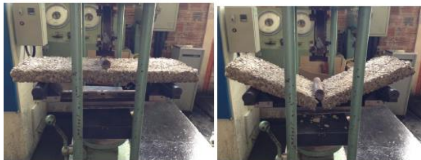
Figura 6 - Rompimento à tração na flexão do concreto 1:3:5 (3% + ABS.)
