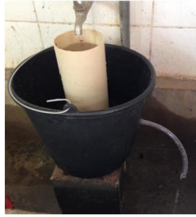
Figura 4 – Ensaio de permeabilidade do concreto à carga constante
