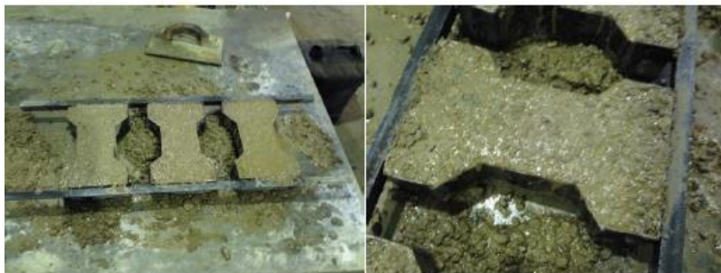
Figura 5 - Peças de piso grama compactados em mesa vibratória
